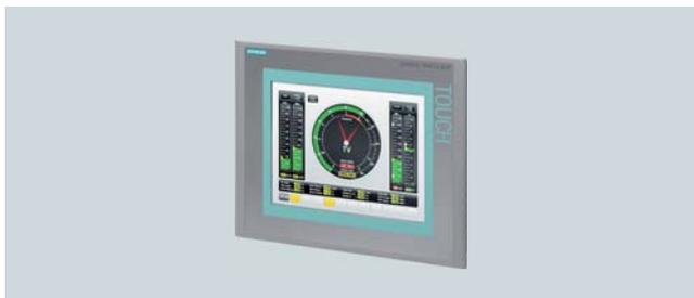
如果操作设备与计算机设备之间的距离较长，那么便建议使用 SIMATIC 精简型客户机。这些经济且又具有灵活性的操作设备可通过 PROFINET/ 以太网来访问各种 HMI 设备或者 PC。SIMATIC 精简型客户机可通过触控的方式来操作，也可以经过 USB 接口连接到外部的键盘或鼠标来进行操作。
