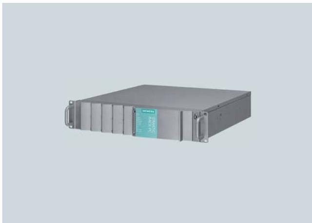
SIMATIC IPC647C 是一款结构坚固，且极为紧凑的工业 PC，具有 19 英寸的设计（2HU）。SIMATIC IPC647C：连接和扩展它尤其适用于在着重节省空间的场合执行快速计算以及可视化的任务，比如，图像和数据处理，或者工业服务器的应用。凭借其只有 2U 的高度以及较浅的安装深度，可以很好地使用在 19 英寸的标准控制柜当中（500 毫米或更深）。
