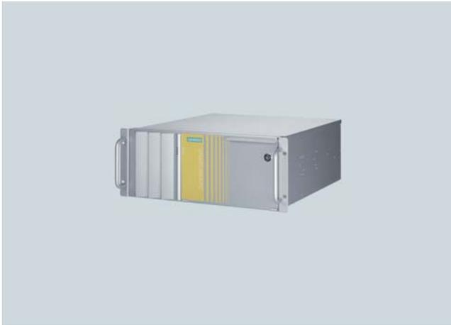
SIMATIC 机架式 IPC547D 是一款功能强大的工业 PC，具有 19 英寸的设计（4RU）它提供了最佳的计算系统以及图形性能，可以快速处理大量的数据，比如可应用在现场的工业图像处理以及可视化处理之中，可承受高达 40 °C 的环境温度。
